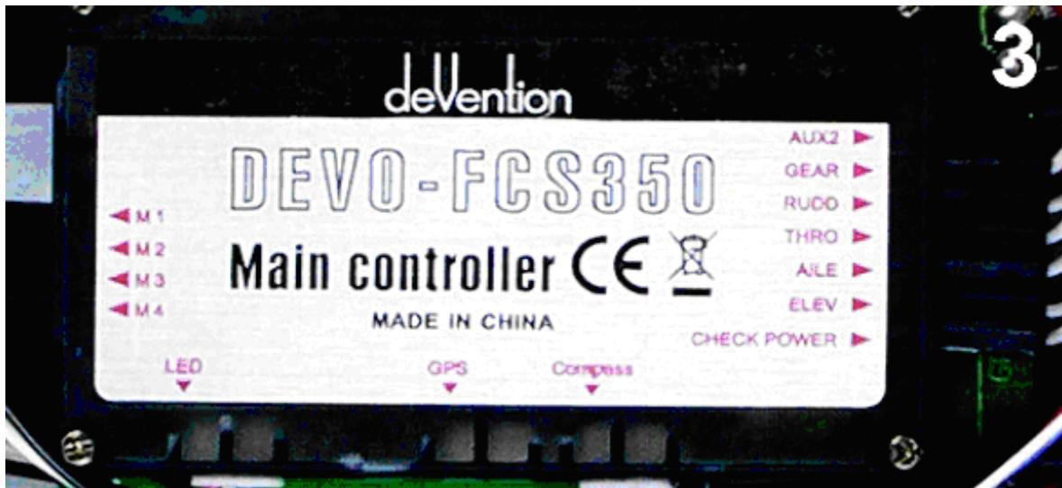
Am eingebauten Mainboard Devo-FCS350 laufen alle wichtigen Informationen zusammen. Hier werden neben den Motoren und Reglern auch das Kompass Modul und das GPS angeschlossen. Das Mainbord ist direkt mit dem RX-702 verbunden. Sind Sie Besitzer eines Senders vom Fremdherstellern, haben Sie hier auch die Möglichkeit, den RX gegen den des Fremdherstellers einzusetzen. Powerboardanschlüsse 1,2,3, 4.
